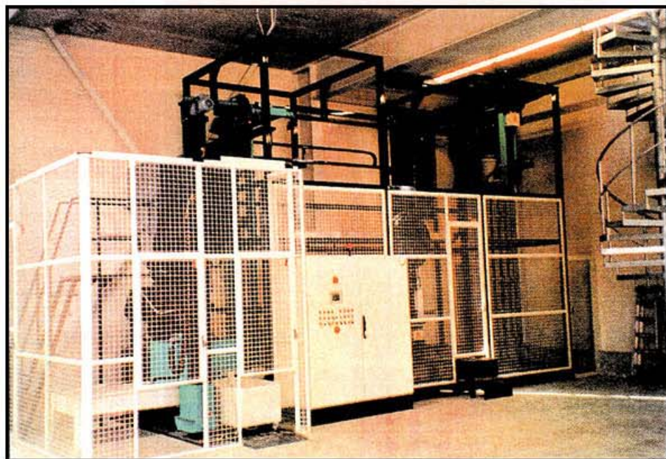
Voici un exemple de ligne flexible pour le traitement automatique multi-copeaux trois huiles réalisée par l'entreprise Henri Petit-Jean.
