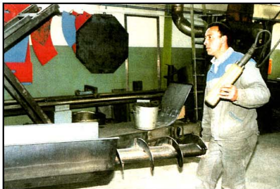
Nous assistons ici au pré-assemblage d'un convoyeur pour transfert des copeaux en so-
